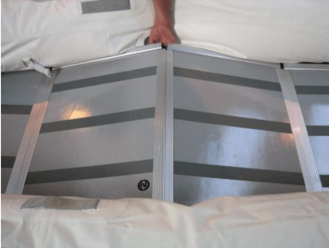
Afbeelding 2. Maak een 'bruggetje' en klik de middelste vloerdelen in elkaar. Druk vervolgens aan om de vloer in elkaar te laten klikken.
