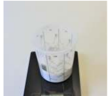
Fig. 2: 350 gram poeder wordt in een maatbeker gedaan.
