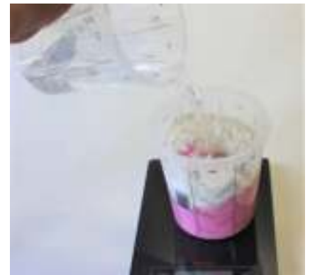
Fig. 3: 1400 gram water wordt aan de alginaat toegevoegd.
