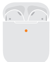
Not fully charged Partiellement rechargés Parcialmente cargados 充電未完了
