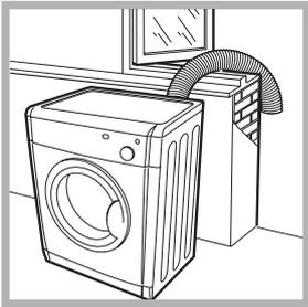
1. Das Schlauchende sollte nach unten zeigen, um verhindern zu können, dass warme feuchte Luft im Raum oder Wäschetrockner kondensiert.
