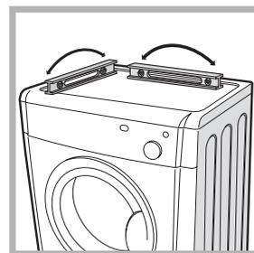
Eine präzise Nivellierung verleiht dem Gerät die erforderliche Stabilität.
