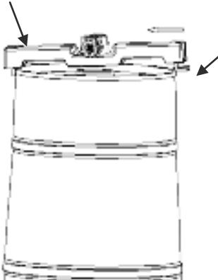
Debe sacar el sujetador a la derecha en primer lugar, a continuación, empuje el cierre de la izquierda como indica la flecha, se puede sacar la unidad de dispensación finalmente.
