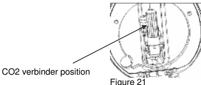
1. De Heineken-verbinder die wordt geleverd met uw bierkoeler kan werken met alle Heineken 5 liter fusten. Toch moet u een platte schroevendraaier gebruiken om de groene basis van het fust te verwijderen om de nieuwe verbinder, voorzien van het bierkoeler installeren.
