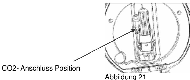
1. Die Heineken-Anschluss, der mit Ihrem Bierkühler kommt, kann mit allen Heineken 5 Liter Fässchen arbeiten. Allerdings müssen Sie einen flachen Schraubendreher verwenden, um die grüne Basis aus dem Fass zu entfernen, um den neuen Verbindungsstecker zu installieren, der dem Bierkühler zur Verfügung gestellt ist.
