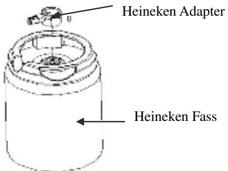
Hinweis: Bitte nehmen Sie den Heineken-Adapter mit Verbindungsmöglichkeit, drücken sie dementsprechenden Pfeil, oder es wird das Befestigungselement beschädigen.
