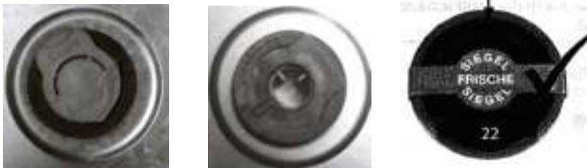
\* La differenza tra i sigillanti con codice n° 23 e 24 è la quantità di chiusure di sicurezza. Sollevare la chiusura di sicurezza con attenzione, girarla ed estrarla dal fusto; sostituire il sigillante (come per i sigillanti con codice n° 2) previsto con l'apparecchio, collegarlo al fusto di birra, e forare facendo perno con l'apparecchio (come mostrato in figura 1).
