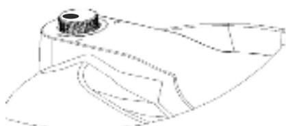
4. Lösen Sie die CO2-Mantelflasche (Siehe Abbildung 15), legen Sie eine 16 Gramm CO2-Patrone in der Hülle (Abbildung 16), und schrauben Sie den Mantel fest, bis Sie ein "Klick" (Abbildung 17) hören, dies zeigt, dass die Patronendichtung durchstochen wurde und das CO2-Gas frei in das Bierfass fließen kann. Stellen Sie sicher, dass die Mantelflasche fest fixiert ist, um CO2-Leckage zu vermeiden. Dann legen Sie die CO2 Mantelflasche in die obere Abdeckung.
