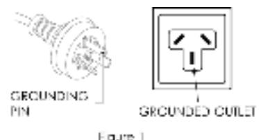
Dit apparaat bevat een aardaansluiting voor alleen deze gebruiksfunctie.
