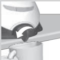
**3** Hold en kopp/panne (med en kapasitet på minst 350 ml) under EASY DE-CALC-bryteren, og vri bryteren mot klokken.
