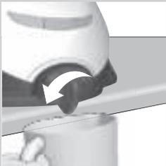
**3** Håll en kopp (med en volym på minst 350 ml) under EASY-DE-CALC-knappen och vrid knappen moturs.
