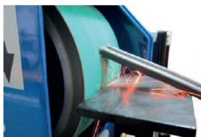
Afb. 20: De vonken worden naar beneden gericht als de draairichting correct is
