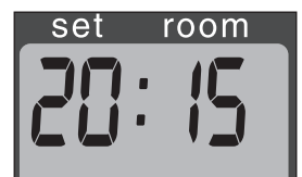
F: Wenn die 4-Stellige Zahl nicht mehr blinkt, sind die Einstellungen gespeichert.
