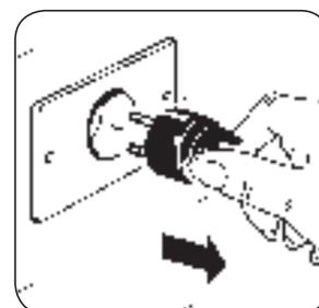
3. Com uma chave de fenda (não fornecida juntamente) remover os parafusos. Desmontar o filtro de ar, limpá-lo com um detergente (não usar gasolina, álcool ou diesel ou outros produtos similares) e enxugá-lo.
