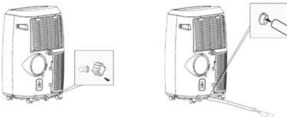
Figure 7 Écoulement de la cuve de sol
