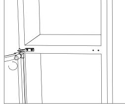
12. Plaats nu de bovendeur en schroef het bovenscharnier vast.
