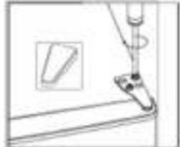
3. Enlevez le cache en haut à gauche de l'appareil à l'aide d'un tournevis plat.
