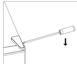
2. Schroef het bovenscharnier los m.b.v. een kruiskop schroevendraaier.
