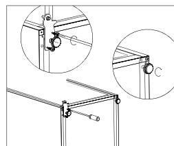
10. Zet het apparaat weer rechtop en plaats de deur op het onderscharnier. Controleer of de scharniergevoed in het scharnierengat onderin de deur zit. Verplaats nu de afdekplaatje van de schanieropening van de onderdeur van de linker- naar de rechterzijde.
