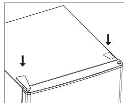
14. Trek de afdichtingsrubbers van de deur(en) los, draai 180° en druk deze weer terug op zijn plaats.
