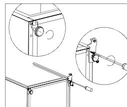
8. Schroef de scharnierpen van hetunderscharnier los, draai de beugel om
