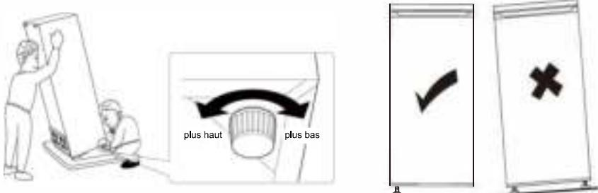
Vous pouvez mettre l'appareil à niveau en ajustant les 2 pieds réglables à l'avant de l'appareil. Si l'appareil n'est pas bien mis à niveau, les portes ne se fermeront pas correctement.
