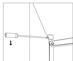
4. Haal de afdekdoop van het scharnierengat eraf en plaats deze aan de andere zijde erop. (zie afbeelding. Licht nu de deur eraf en leg deze op een zachte ondergrond beschadigingen te voorkomen.
