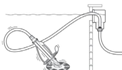
La aspiración del fondo (por ejemplo, con Ubbink PoolCleaner Auto, nº de art. 7500401) tiene lugar en la posición FILTRAJE (de la válvula de varias vías). Es necesario conectar el aspirador del fondo al tubo flexible del aspirador del skimmer. Debe desconectarse La bomba del grupo de filtraje.
