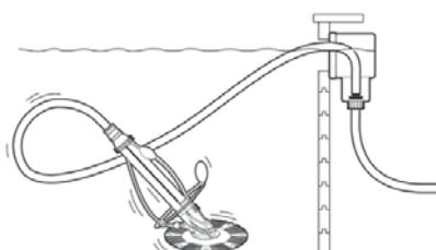
Het zuigen van de bodem (bijv. met Ubbink PoolCleaner Auto, art.nr. 7500401) vindt plaats in de stand FILTEREN (op de meerwegklep). De bodemzuiger moet met de bodemzuigslang worden aangesloten op de skimmer. De pomp van de filterinstallatie moet uitgeschakeld zijn.
