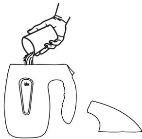
Vul het waterreservoir met schoon water. Zorg ervoor dat het water niet boven de MAX-lijn komt (140 ml).
