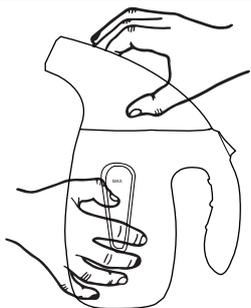
Doe de stekker nog niet in het stopcontact. Draai het mondstuk en open de kledingstomer.
