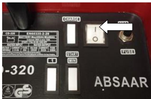
Während des Aufladevorgangs darf die Temperatur der Elektrolyt-Lösung in der Batterie 45° nicht übersteigen, wenn der Ladevorgang nicht abgeschlossen ist und damit die Temperatur 45° C erreicht, muss die Ladestärke verringert werden, um die Zeit zu verlängern und die Temperatur der Lösung bis zum Ende des Aufladevorgangs zu verringern.
