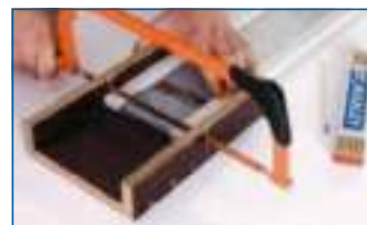
Snijden van de profielen op de noodzakelijke lengte.
