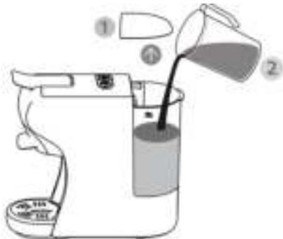
Verwenden Sie eine Kanne und füllen Sie diese mit normalem, kaltem Wasser.
