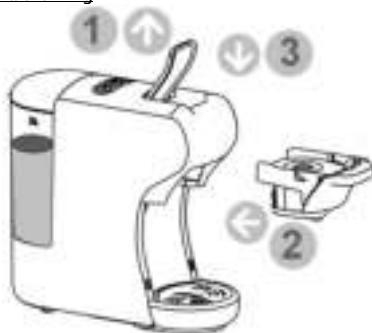
Til de hendel op en breng een lege adapter aan (zonder pads/cups of koffie). Laat de hendel zakken om hem te sluiten. Plaats een grote kop (min. 250 ml) op het afneembare rooster.
