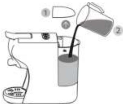
Vullen door het waterreservoir te verwijderen
