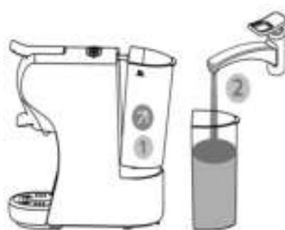
Nehmen Sie den Wassertank durch leichtes Kippen vom Gerät ab; füllen Sie den Wassertank mit kaltem, stilem Wasser bis zu seinem MAX-Stand (600 ml). Setzen Sie den Wassertank wieder an seinen Platz ein, indem Sie ihn langsam auf den Boden schieben und dabei darauf achten, dass sich die Wasserablaufleitung innerhalb des Wassertanks befindet. Drücken Sie dann fest auf den Tank, um sicherzustellen, dass er sicher an seinem Platz sitzt. Setzen Sie den Deckel auf den Wassertank.
