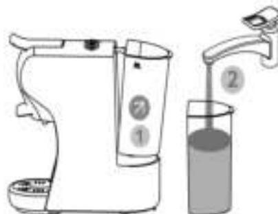
Retirez le réservoir d'eau de l'appareil en l'inclinant légèrement ; remplissez le réservoir d'eau plate et froide jusqu'à son niveau MAX (600 ml). Remettez le réservoir dans son emplacement en le faisant glisser lentement jusqu'à la base, en veillant à ce que le tuyau de sortie d'eau soit à l'intérieur du réservoir. Appuyez ensuite fermement sur le réservoir pour vous assurer qu'il est bien mis. Replacez le couvercle sur le réservoir.
