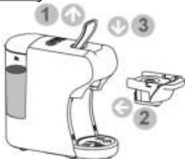
Ziehen Sie den Hebel hoch und setzen Sie einen leeren Adapter (ohne Kapseln und Kaffee) ein. Senken Sie den Hebel ab, um ihn zu schließen. Stellen Sie eine große Tasse (min. 250 ml) auf das abnehmbare Gitter.
