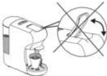
**⚠ Risque de coupure ! Ne touchez pas le haut du compartiment à capsule, il y a une aiguille de perforation pointue.**
