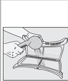
Une couche peut se former sur les pores du filtre et entraîner un bouchage du filtre après avoir utilisé la machine pendant un certain temps. Lavez le filtre à l'eau chaude pour enlever la couche qui se forme sur la surface du filtre. Séchez le filtre complètement avant de le réinstaller.
