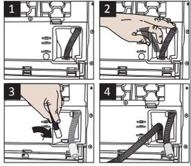
**1-2** Tirez à la main le tuyau derrière le sèche-linge afin de le débrancher de son point de connexion. N'utilisez aucun outil pour retirer ce tuyau..
