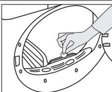
Er bevinden zich vochtigheidssensoren in de droger die detecteren wanneer het wasgoed droog is of niet. Het reinigen van de sensoren:
