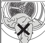
Zorg ervoor dat er geen wasgoed geklemd zit tussen de laaddeur.
