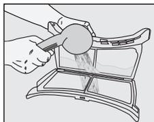
Op de pluisfilterporieën kan, na uw machine enige tijd te gebruiken, een laag ontstaan die verstopping van het pluisfilter kan veroorzaken. Was het pluisfilter met warm water om de opgebouwde laag op het oppervlak van het pluisfilter te verwijderen. Droog het pluisfilter volledig voordat u het terugplaatst.
