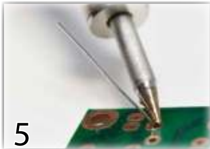
Heat part lead & PCB pad - Verwarm het uiteinde van de aansluitdraad en het printplaatje - Réchauffez l'extrémité du fil de connexion et le circuit imprimé - Erhitzen Sie den Anschlussdraht und die Lötstelle - Caliente una parte del hilo junto a la placa CI
