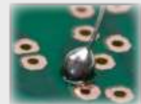
Too much solder - Te veel soldeersel - Trop de soudure - Zu viel Lot - Soldado en exceso
