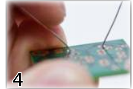
Bend leads - Plooi de aansluitdraden - Pliez les fils de connexion - Biegen Sie das Drahtende um - Pliegue los hilos
