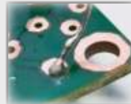
Too little solder - Te weinig soldeersel - Pas assez de soudure - Zu wenig Lot - Poco soldado
