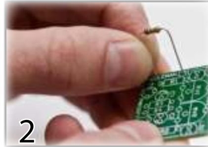
Insert part against PCB - Monteer het onderdeel tot tegen het printplaatje - Montez le composant contre le circuit imprimé - Montieren Sie das Bauteil bis gegen die Leiterplatte - Ponga la pieza junto al CI
