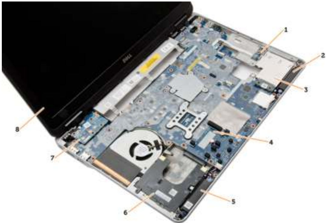
Afbeelding 2. Bovenaanzicht: toetsenbord en polssteun verwijderd
