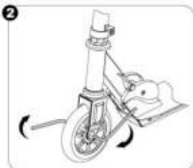
Aperte bem o parafuso como mostrado.
