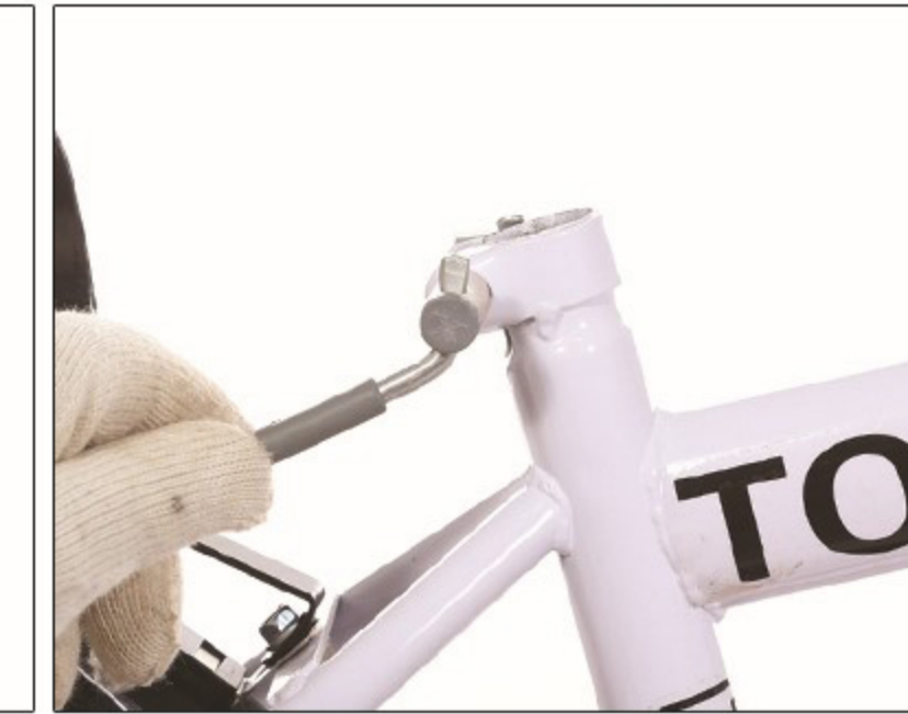
10. Plaats de zadelpen in het frame en draai deze vast
