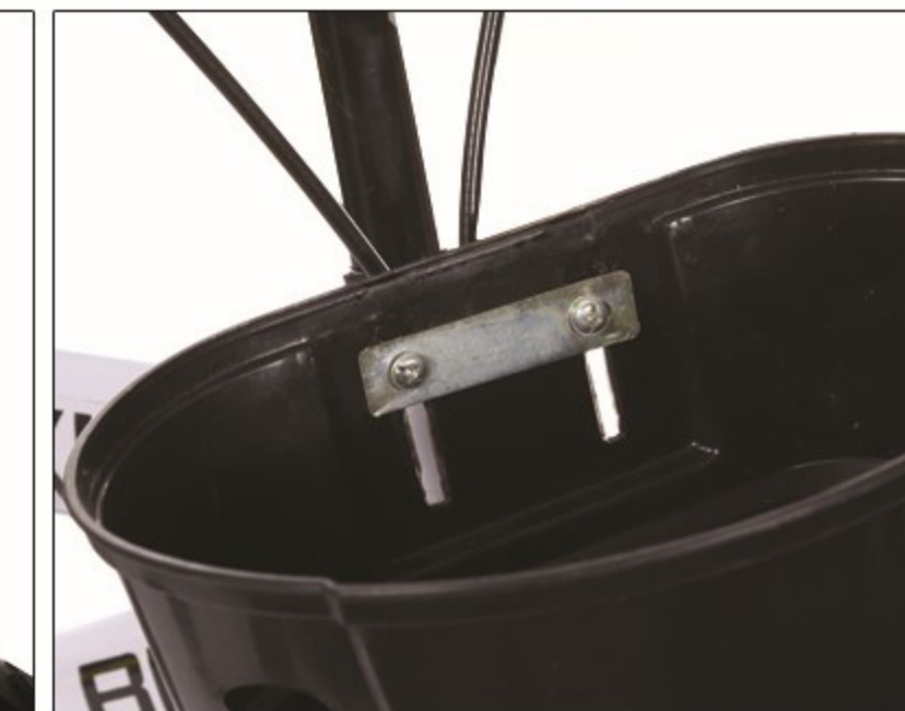
14. Aanbrengen fietsmandje voorop. De Generation Good heeft een andere aansluiting om het mandje te bevestigen
