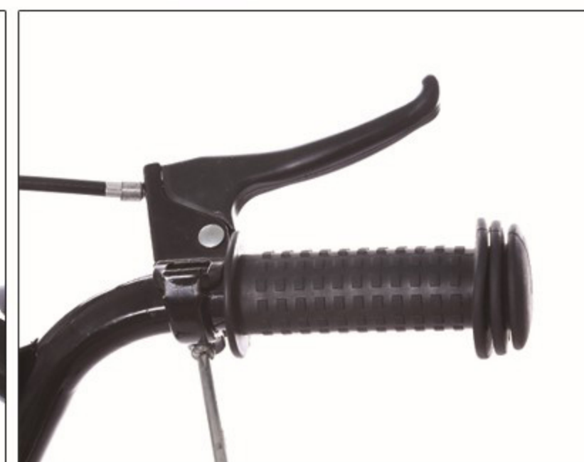
16. Bevestig de remkabel aan de handrem.
