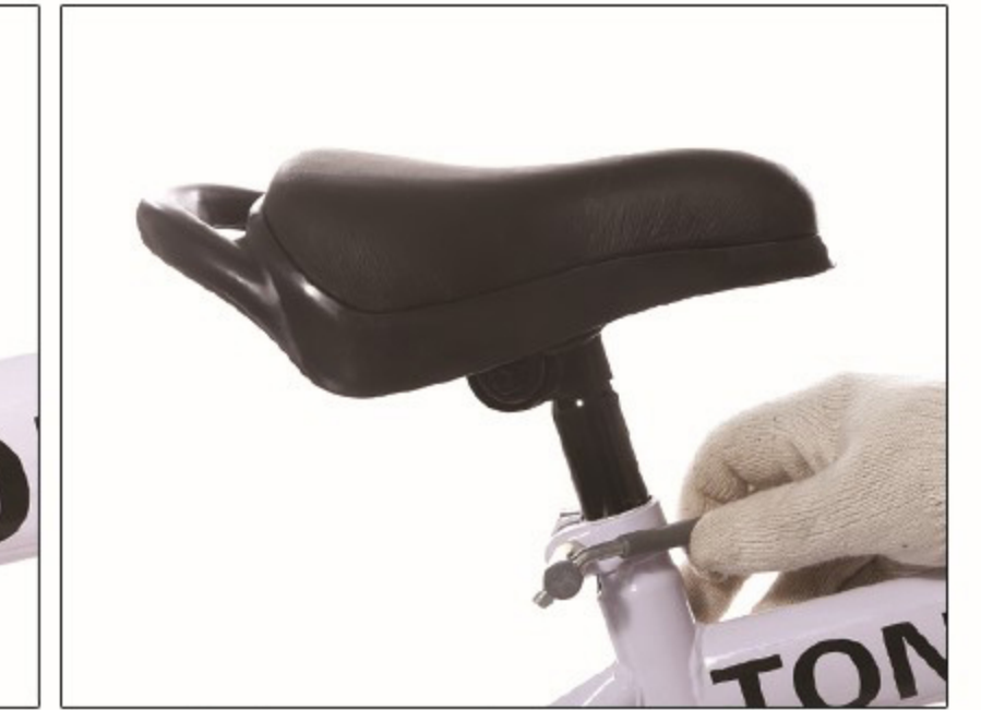
10. Plaats de zadelpen in het frame en draai deze vast
