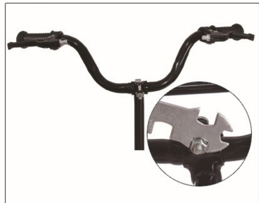
11. Het stuur rechtzetten en vastdraaien
