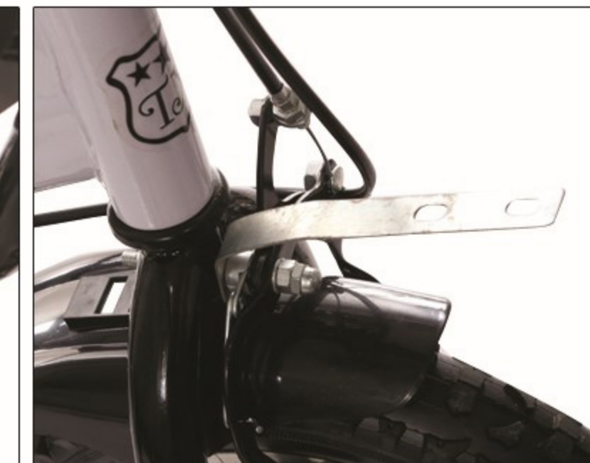
14. Aanbrengen fietsmandje voorop. De Generation Good heeft een andere aansluiting om het mandje te bevestigen
