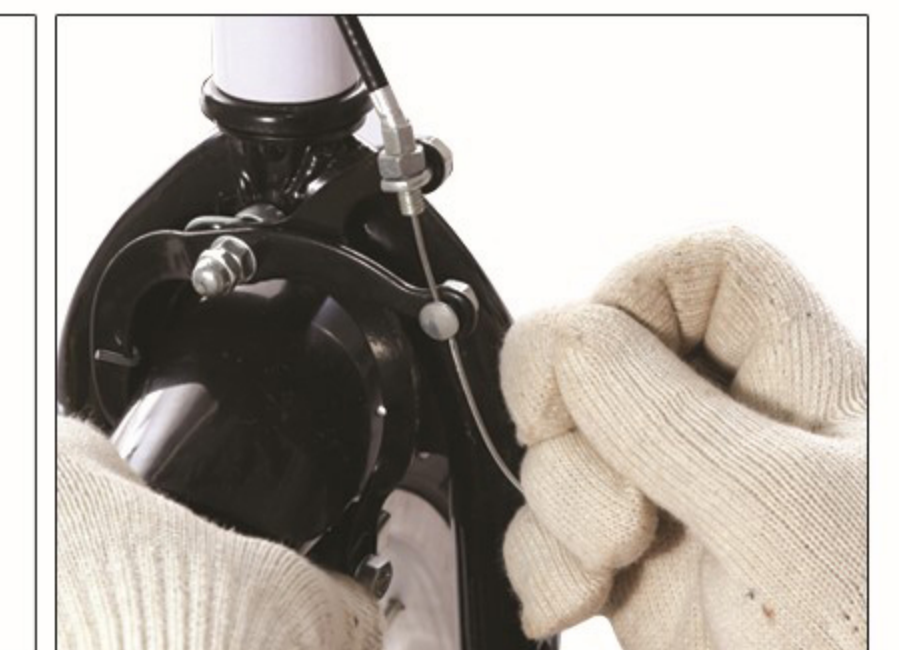
18. Knijp de voorrem bij mekaar en trek de remkabel aan
