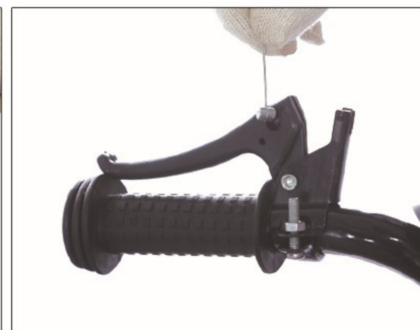
16. Bevestig de remkabel aan de handrem.
