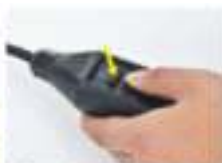
Stlačte tlačidlo „TEST“, kontrolka zhasne
