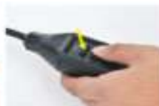
3. Druk op de "TEST"-knop en het indicatorlampje dooft.
