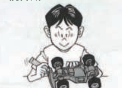
⑧ギヤや軸受けは、サスペンションなどの可動部はグリスを塗っておきましょう。
