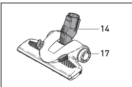
La buse combinée (17) est équipée d'une rotule rotative qui offre une grande facilité d'utilisation. Les poils normaux et fins de la buse peuvent être facilement remplacés si usés. La buse combinée peut-être ajustée sur les sols durs par simple pression (26) (poils dehors) ou tapis (poils rentrés). Elle est aussi équipée de pièces métalliques en acier inoxydable.
