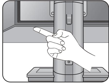
Schalten Sie den Monitor mit der Ein-/Aus-Taste am Monitor ein und aus.
