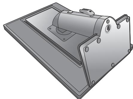
Ziehen Sie den Ständer in die maximale Länge. Drehen Sie den Monitor um 90 Grad gegen den Uhrzeigersinn, wie in der Abbildung gezeigt wird.
