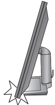
Wenn Sie den Monitorständer weiter herausziehen möchten, drücken Sie auf den unteren Teil des Hebels für die Höhenverstellung, während Sie den Monitor an dessen Unterseite festhalten. Ziehen Sie dann Ständer und Monitor zusammen nach oben, bis die gewünschte Höhe eingestellt ist.
