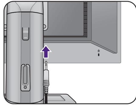
Sie können Kopfhörer an die Kopfhörerbuchse links am Monitor anschließen.
