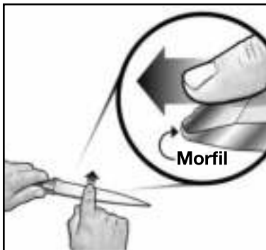
Figure 2. Formez un morfil distinct le long du fil de la lame avant d'affiler dans le module 2. Le morfil peut être détecté en glissant le doigt en travers et en s'éloignant du fil. Attention! Voir texte.
