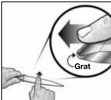
Abbildung 2. Erstellen Sie vor dem Schleifen in Stufe 2 einen deutlichen Grat entlang der Messerschneide. Der Grat kann festgestellt werden, indem Sie den Finger über und von der Schneide weg gleiten lassen. Achtung! Siehe Text.
