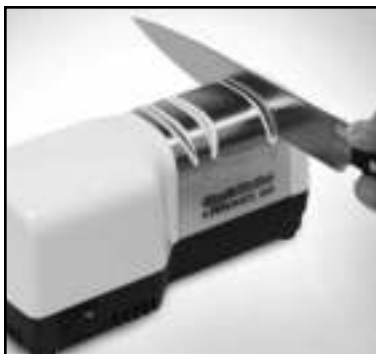
Figure 4. Couteau dans le module 2. Faites des mouvements de va-et-vient pour aiguiser en appliquant une pression vers le bas modérée. Voir texte.
