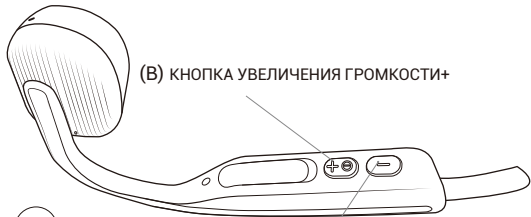
(C) КНОПКА ВКЛЮЧЕНИЯ; КНОПКА УМЕНЬШЕНИЯ ГРОМКОСТИ-
