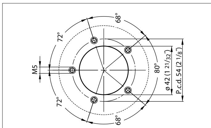
**Aansluiting voor tankniveausensor:**
