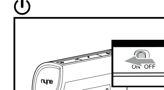
G. Deslice el interruptor de encendido hasta que quede en posición ON.
