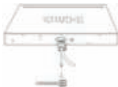
Figura 2-3. Deslice el retenedor a través de la banda de sujeción
