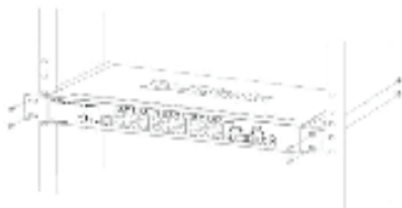
Figure 4. Installation du switch dans une armoire de taille standard
