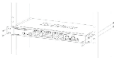
Abbildung 4: Switch im Standardrack installieren
