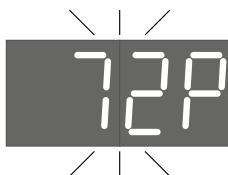
Om de maximale temperatuur in te stellen, druk op een willekeurige knop. De ingestelde kamer temperatuur 'C' verschijnt en begint te knipperen. Terwijl deze waarde knippert, druk beide knoppen in en houdt deze ten minste 2 seconden ingedrukt. Na een toon signaal zal de display de ingestelde maximale oppervlakte temperatuur 'P' weergeven en deze laten knipperen. Stel de gewenste waarde en, en wacht 6 seconde om de instelling op te slaan en uit het menu te gaan
