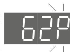
**Attentie!** Indien de oppervlakte temperatuur constant weergegeven wordt, betekent dit dat de externe thermometer niet aangesloten of beschadigd is. Tegelijkertijd zal de oppervlakte temperatuur van de verwarming constant op de ingestelde waarde 'P' (zie beneden) gehouden worden, ongeacht van de kamer temperatuur.
