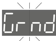
✓ De thermostaat kan bij het aanzetten en tijdens werking van de verwarming controleren of er een aarde aanwezig is. Bij afwezigheid wordt dit waarschuwingssymbool (links) weergegeven, en wordt (indien deze functie is geactiveerd) de verwarming uit gezet terwijl deze op aarde wacht, of tot de gebruiker de verwarming handmatig reactiveert zonder aarde.
