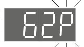
**Achtung!** Wenn die Oberflächentemperatur des Heizgerätes ständig angezeigt wird, dann ist der Fernbedienungssensor nicht angeschlossen oder beschädigt. Dabei, unabhängig von der Raumtemperatur, wird die Heizeroberfläche kontinuierlich zum eingestellten Wert „P“ (s. unten) erwärmt.
