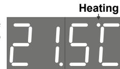
● **Einstellung der Raumtemperatur.** Drücken Sie eine Taste. Der eingestellte Temperaturwert «C» wird angezeigt und beginnt zu blinken. Solange der Wert blinks, kann man durch Drücken von Tasten die eingestellte Temperatur(für Autorepeat-Funktion muß man die Taste halten) ändern. Wenn die Taste nicht mehr als 5 Sekunden nicht gedrückt wird, wird der Austritt aus dem Regime der Einstellung durchgeführt (Wert stoppt zu blinken).
