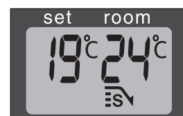
J: Als het lampje SAVE oplicht, slaat de kachel automatisch aan en uit, om binnen een bepaald temperatuurbereik te blijven.
