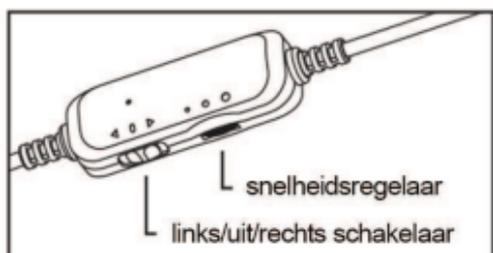
**Stap 4.** Gebruik de links/uit/rechts schakelaar op de USB-kabel om het aan of uit te zetten en draairichting te kiezen (handvoorkeur). Gebruik de snelheidsregelaar om de snelheid aan te passen. Klaar voor gebruik.
