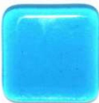
2 laagjes, totaal 6 mm dik Geen vormverlies, de hoekjes worden mooi afgerond
