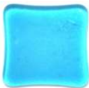
1 laagje, 3 mm dik De vorm trekt naar binnen toe
