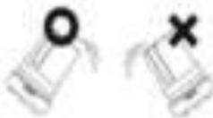
3. Wischen Sie den Wassertank mit einem Tuch ab, das in mildes Küchenwaschmittel getaucht und in warmem Wasser gelöst und gut ausgewrungen ist. Reinigen Sie die Ultraschallplatte und die Geräteabdeckung mit einem Wattestäbchen. Berühren Sie die Ultraschallplatte nicht direkt und üben Sie keine starke Kraft auf sie aus.
