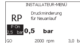
Abbildung 17: Einstellung des Neustartdrucks
