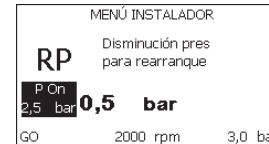
Figura 17: Configuración de la presión de reencendido
