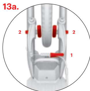
13a. Nastavenie brzdy (V-brzda)
