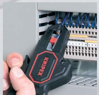
Abisolieren unter beengten Platzverhältnissen
