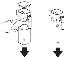
**2** Para desmontar o montar la boquilla de la leche, colóquela en posición vertical.
