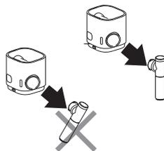
**3** Pulse el botón en el costado del depósito de leche y tire para desbloquear el racor.
