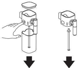
**2** Aby šlo výpust mléka demontovat a znovu smontovat, otočte ji do svislé polohy.
