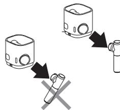
**3** Drücken Sie die Taste an der Seite des Milchbehälters und ziehen Sie, um das Anschlussstück auszurasten.
