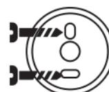
**3.** Insérez soigneusement les chevilles dans les trous avec un marteau approprié
