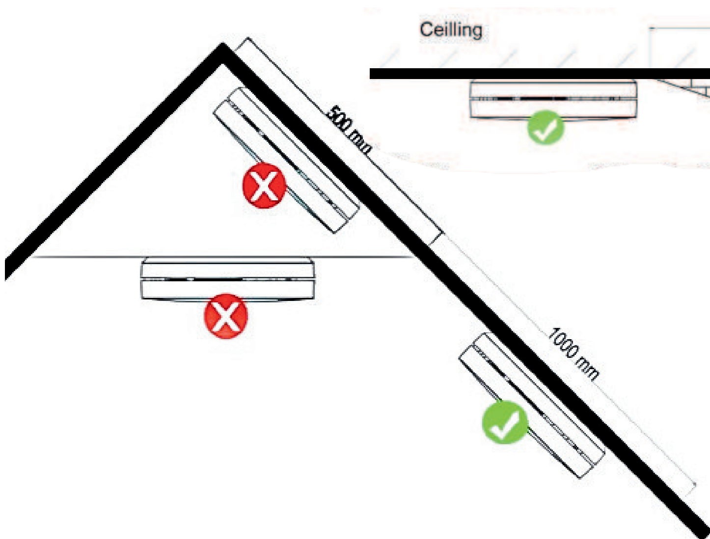
Figura 4: posizioni di montaggio consigliate
