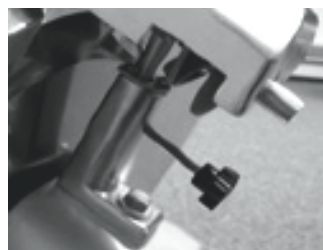
3. Zaciśnij uchwyt, aby ostrzałka pozostała nieruchomo na miejscu. Przed użyciem urządzenia upewnij się, że ostrzałka jest stabilnie zamontowana.
