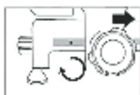
④ Tournez le bouton pour régler l'épaisseur dans le sens des aiguilles d'une montre pour déverrouiller la trancheuse.
