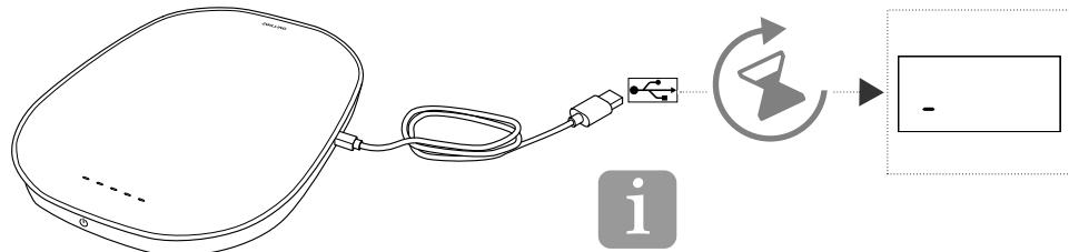
Durante el proceso de carga, un segmento de la pantalla se mueve de derecha a izquierda.
