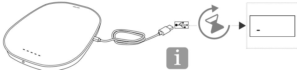
Durante o processo de carga, um segmento na indicação avança da direita para a esquerda.
