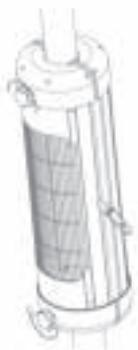
Ajustez la position du radiateur (à au moins 50 mm du sol) puis fixez-le en tournant les deux boutons de verrouillage en forme d'étoile dans le sens des aiguilles d'une montre.
