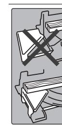
$\theta$  max. 216mm สังเกตขนาดของใบเลือย เส้นผ่าศูนย์กลางต้องเข้ากับแกนหมุนของเครื่องโดยไม่มีช่องคลวง อย่าใช้ช้อนลดหรือข้อปั๊บ
