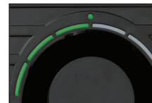
i driftstypen "Purifier" (Luftrensing) lyser LED-ene grønt
