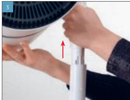
3 Najskôr odstráňte jednotku ventilátora tak, že ju pevne vytiahnete smerom nahor.
