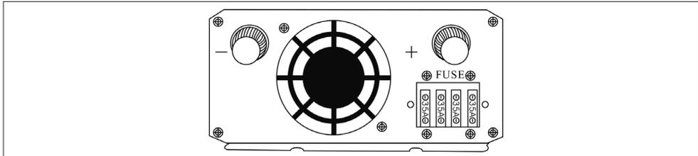
J.Kühlventilatoren / Lüftungsfenster
