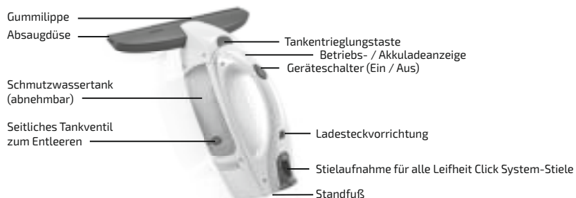
Abbildung 2: Fenstersauger Bedienelemente
