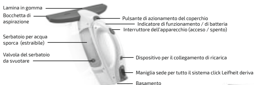
Figura 2: Dispositivi di comando del puliscivetri
