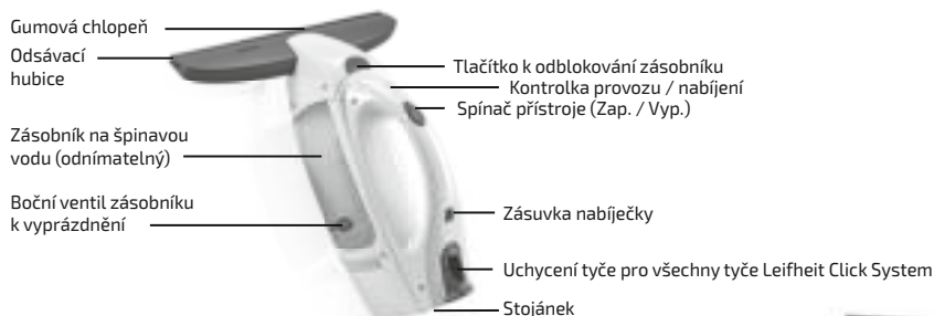
Obrázek 2: Obslužné prvky okenní odsávačky
